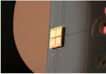
**Vier LED-Chips** sind unter einem Reflektor angeordnet
